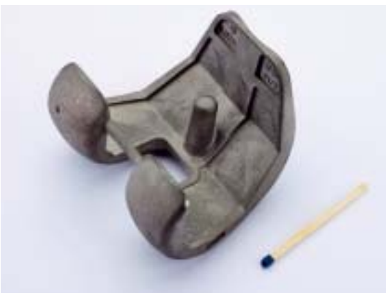
Mikrobearbeitung von Implantaten mit Wasser: Das hochpräzise Verfahren hat keinen Einfluss auf die thermische Spannung und die Gefügestruktur des Werkstoffs. Bilder: Microwaterjet
